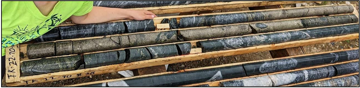
Abbildung 2. Nahaufnahme des massiven Pentlandit-Pyrrhotin-Chalkopyrits in Bohrloch TK-22-070.
