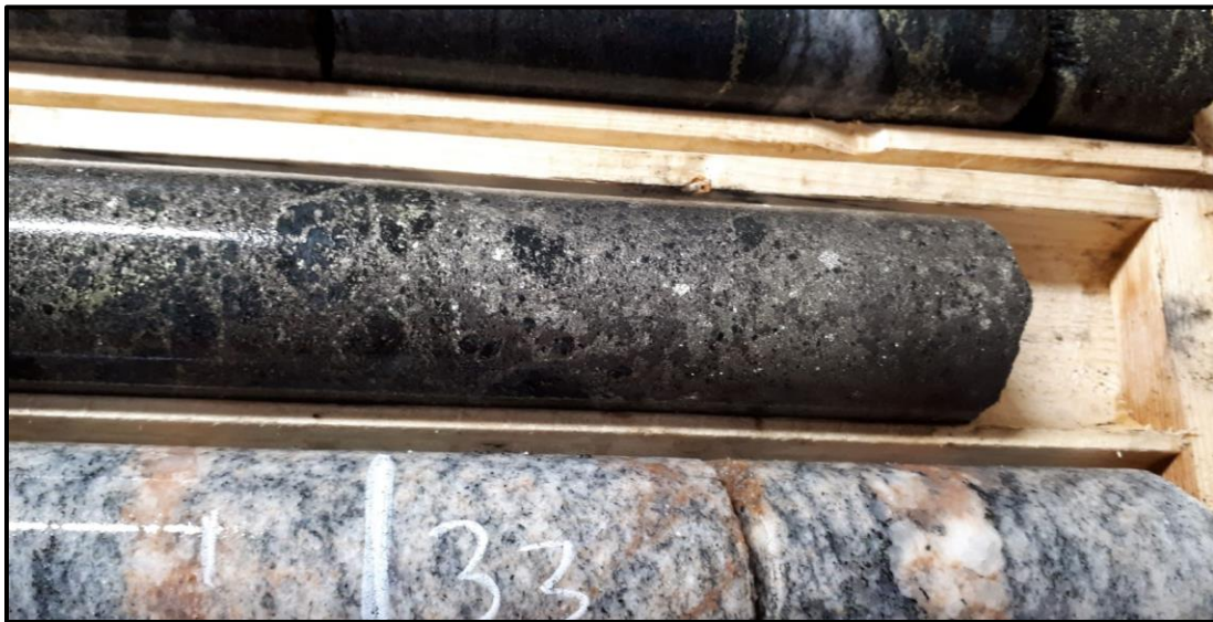
Abbildung 4. Nahaufnahme der Durchschneidung von massivem magmatischem Sulfid in Bohrloch TK-20-015
